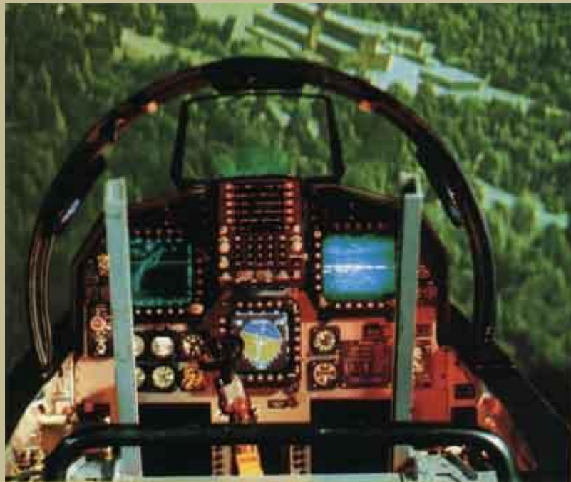
Panel de control de un f-15 Eagle - En el centro se observa el indicador de actitud Obsérvese que es el reloj central del panel de control
