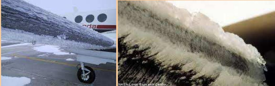
Es el depósito de hielo sobre la aeronave en vuelo y se produce cuando el agua líquida subfundida se congela cuando impacta con la misma. **Reduce significativamente la sustentación.** <sup>4</sup>
